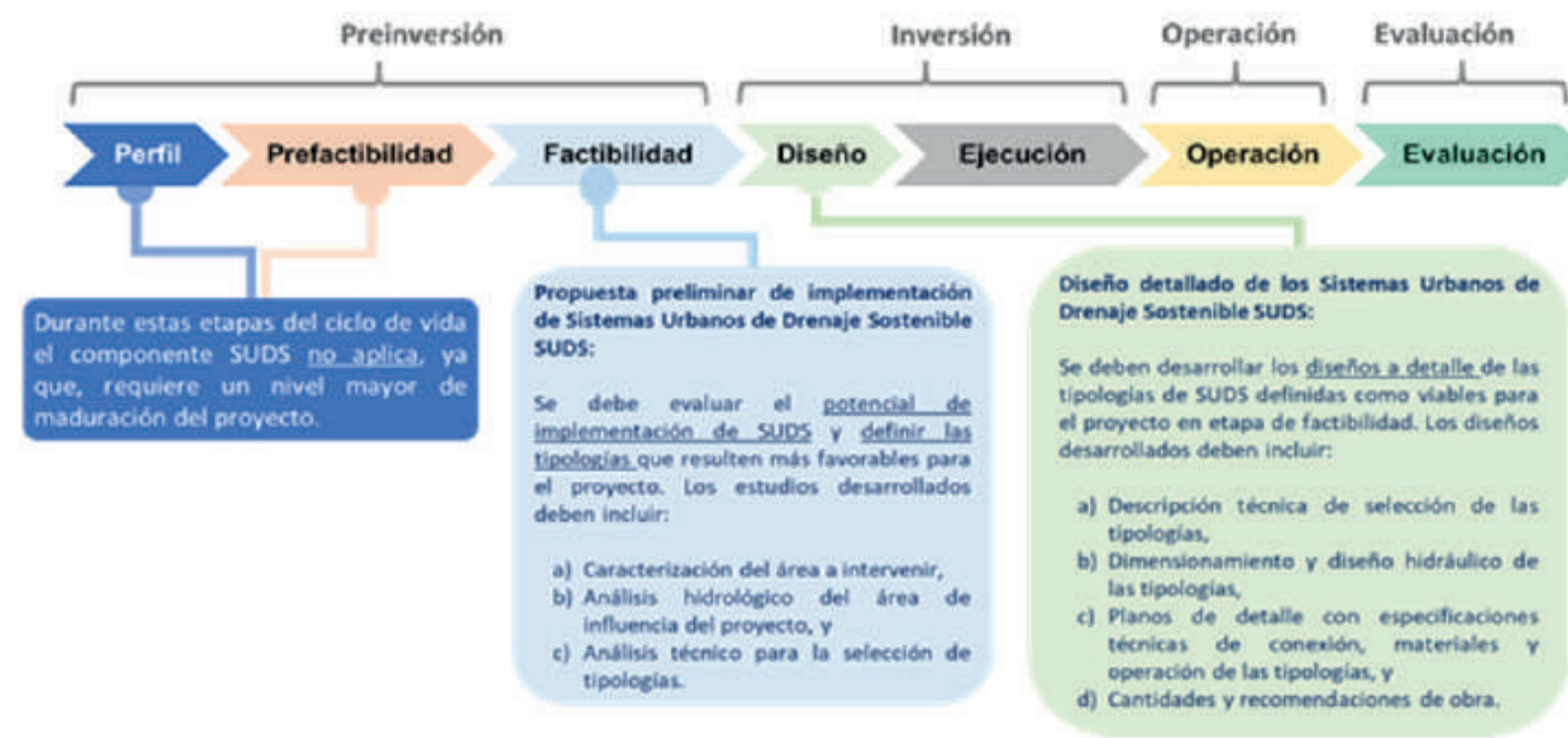
Ilustración 3. Lineamientos y entregables específicos al Capítulo de SUDS dispuestos en la Guía de Maduración de Proyectos.
